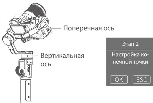
(4) Ручной гиростабилизатор автоматически вращается из исходного в конечное положение. Ручной гиростабилизатор возвращается в исходное положение после выбора параметров, затем поперечная и вертикальная оси начинают двигаться в соответствии с выбранными параметрами.
